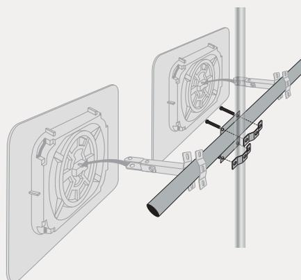
> Pose sur murs et poteaux de 60 à 90 mm de diamètre
